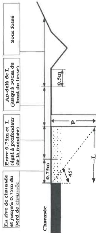
**Schéma n°7 sous chaussée RD cat. 1 niveaux 1 et 2a pour tranchée isolée**
