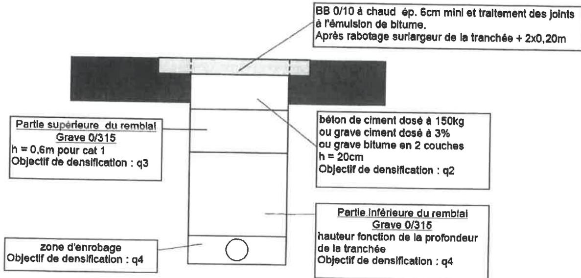
**Schéma n°10 sous trottoir ou sous accotement revêtu RD catégories 1, 2 et 3**
