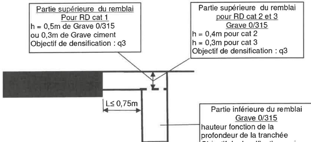
**Schéma 6-1** tranchée sous accotement située à une distance L du bord de c entre 0,75m et P (profondeur de la tranchée) pour les RD des catégories 1,2 €
