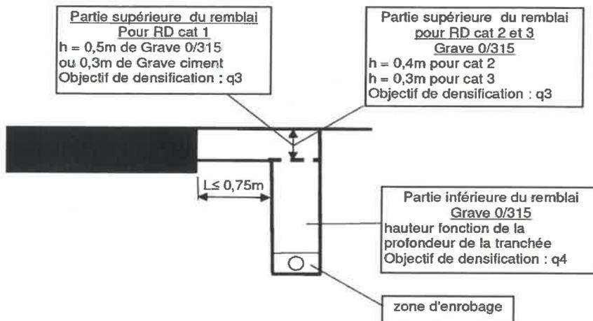
**Schéma n°9** sous chaussée RD catégorie 1 niveau 2b, cat.2 et cat.3 pour tranchée "isolée" et "longitudinale"
