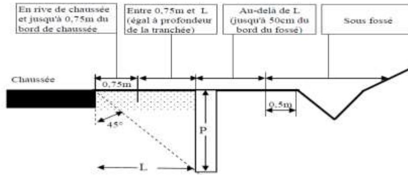
**Schéma 6-1** tranchée sous accotement située à une distance L du bord de chaussée comprise entre 0,75m et P (profondeur de la tranchée) pour les RD des catégories 1,2 et 3
