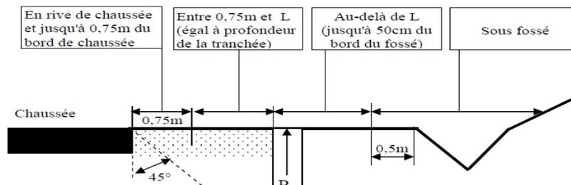
**Schéma n°6-2 tranchée sous accotement située à une distance du bord de chaussée inférieure à 0,75m pour les RD des catégories cat.1, 2 et 3**
