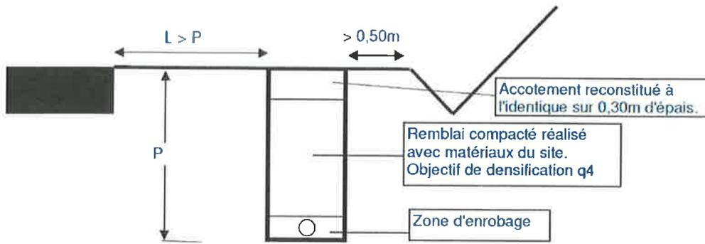
**Schéma n°6-2** tranchée sous accotement située à une distance du bord de chaussée inférieure à 0,75m pour les RD des catégories cat.1, 2 et 3
